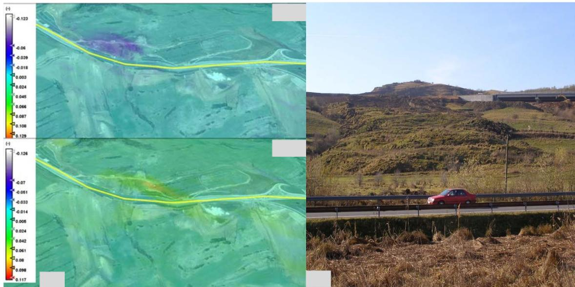
Figure 2 : Les glissement de terrain près de la sortie de l'autoroute de Nădășelu.
