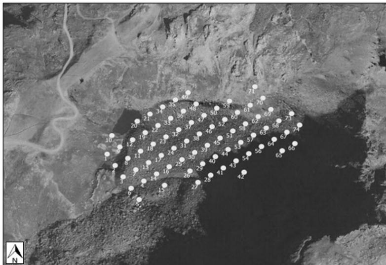
Figure 2. Distribution des capteurs installés sur le glacier rocheux.
