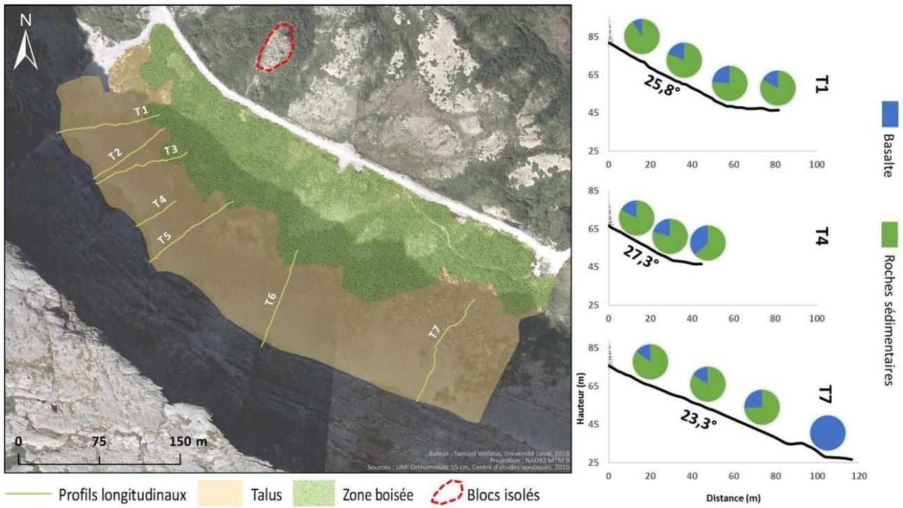
Figure 2 : Profils topographiques et données pétrographiques obtenus sur le talus.
