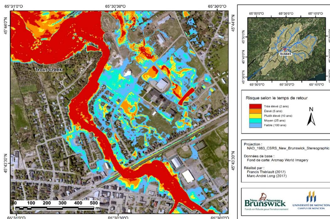
Figure 4 : Risques d'inondation pour une section (Sussex) du bassin versant de la rivière Kennebecasis.
